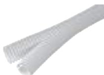
Ce conduit fendu et refermable permet la protection de câbles spécifiques. Le conduit a certes une faible résistance à l'écrasement du fait de sa fente mais est aussi résistant aux chocs qu'une gaine ICTA standard.
